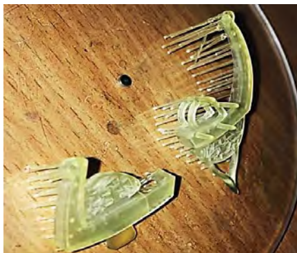
Рис.3. Распечатанная мастер-модель изделия на 3D принтере.
