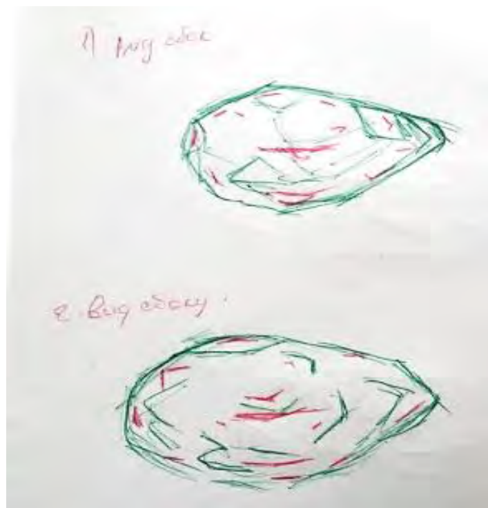
Рис.2. Образец №2: Красным отмечены трещины.
