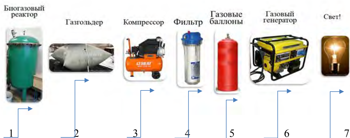
Рис. 3. Оборудование, входящее в технологическую линию адаптированной психрофильной технологии: 1 – метантенк объемом 1 м 3 ; 2 – газгольдер; 3 – компрессор; 4 – фильтр; 5 – газовый баллон; 6 – газовый генератор; 7 – электричество.
